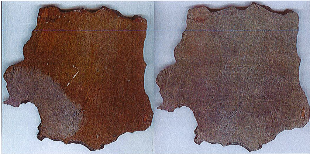
A vasmeteorit lakkréteggel bevont felülete, illetve a lakkréteg eltávolítása után étetéssel láthatóvá váló speciális Widmanstätten-rajzolat
